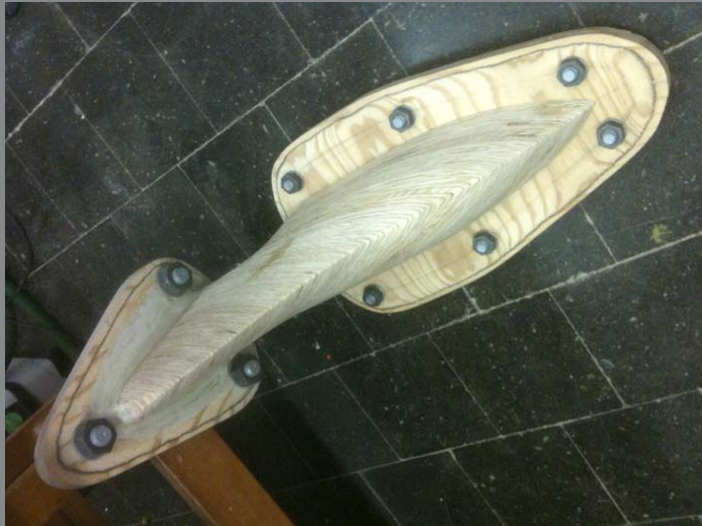
Modell 1:1 des Verbindungsstückes für die Giesserei Benninger in Uetzwil
